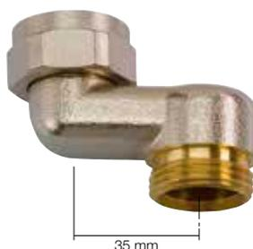
Schlüter-BEKOTEC-THERM-S35 est un raccord en S en laiton nickelé comportant, d'une part, un écrou-raccord conique 3/4" (DN 20) et, d'autre part, un embout de raccordement conique 3/4" (DN 20) pour le raccordement des tubes de chauffage Schlüter de 10, 12, 14 ou 16 mm de diamètre.
