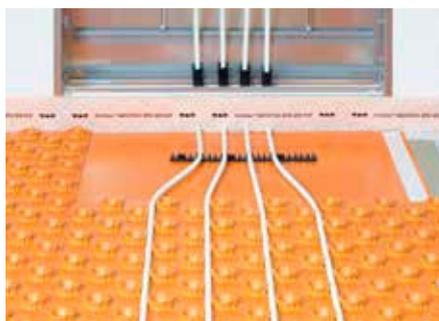
Le panneau de mise à niveau Schlüter-BEKOTEC-ENFGK se monte dans la zone du collecteur afin de faciliter le montage des tubes de chauffage dans le coffret pour collecteur. Le panneau en polystyrène est fixé sous la dalle à plots à l'aide de la bande adhésive double face fournie (6 m).
