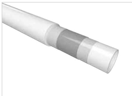
Schlüter-BEKOTEC-THERM-HR est un tube de chauffage à 5 couches en polymère haut de gamme (PE-RT), muni d'une séparation centrale contre la diffusion d'oxygène. Le tube extrêmement souple et conforme à la norme DIN 16833 est spécialement adapté à la pose dans les dalles à plots BEKOTEC. La barrière anti-oxygène est certifiée conformément à la norme DIN 4726 et sa qualité est contrôlée en continu.
