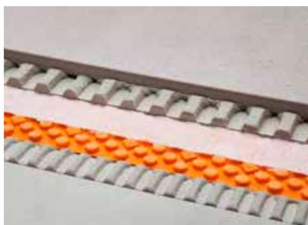
Schlüter-DITRA-DRAIN 4 est une natte en polyéthylène indéformable avec une structure à plots unilatérale et un non-tissé en polypropylène collé sur la face supérieure. Elle s'utilise en combinaison avec les revêtements carrelés en tant que couche de découplage et/ou drainage composite à capillaire passif durablement efficace. Pour pose collée.
