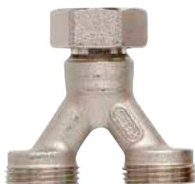
Schlüter-BEKOTEC-THERM-DA est un jeu de raccords doubles en laiton nickelé doté d'un côté d'un écrou-raccord conique 3/4" (DN 20) et de l'autre côté de deux embouts de raccordement coniques 3/4" (DN 20) pour le raccordement des tubes de chauffage Schlüter de 10, 12, 14 ou 16 mm de diamètre.
