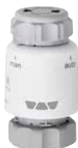
Schlüter-BEKOTEC-THERM-ESA est une électrovanne 230 Volts pour la commande du débit des vannes de retour. Le montage est réalisé par vissage (M30 x 1,5) sur les vannes de retour du collecteur de circuits de chauffage Schlüter, classée IP54 (protection contre les projections).
