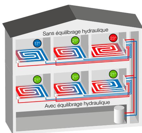
L'équilibrage hydraulique est essentiel pour l'efficacité énergétique des systèmes de chauffage et/ou de rafraîchissement. Il empêche une alimentation déséquilibrée de circuits individuels, garantissant ainsi plus de confort et d'efficacité énergétique. L'équilibrage auto-adaptatif et intelligent permet de diffuser la chaleur de façon plus ciblée par rapport à un équilibrage manuel. Ses avantages :
