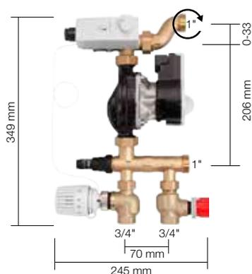
Schlüter-BEKOTEC-THERM-FRS est une station de régulation de maintien pour le réglage de la température de départ. L'installation d'un collecteur de circuits de chauffage (inox ou matière plastique) avec 1 à 12 circuits de chauffage est possible. L'installation peut s'effectuer dans les coffrets pour collecteurs VSE/VSV. La station mélangeuse alimente le plancher chauffant-rafraîchissant BEKOTEC-THERM en basse température de départ nécessaire.
