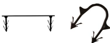
Schlüter-BEKOTEC-THERM-RH sont des cavaliers en matière plastique dotés de crochets latéraux pour la fixation des tubes de Ø 16 mm aux endroits particulièrement critiques. La taille 75 est prévue pour plusieurs tubes, la taille 17 pour un tube.
