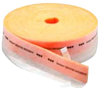
Schlüter-BEKOTEC-BRS/KF est une bande périphérique en mousse de polyéthylène, à cellules fermées, comportant une embase à coller et une bande autocollante pour la fixation au mur. Cette embase comporte une bande autocollante sur sa partie supérieure, pour recevoir et fixer les dalles à plots, et éviter que les chapes autolissantes ne coulent sous les dalles lors de leur mise en œuvre.
