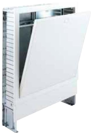
Schlüter-BEKOTEC-THERM-VSE est un coffret pour collecteur à encastrer, prévu pour loger un collecteur de circuits de chauffage Schlüter et les composants de régulation correspondants. Le coffret à encastrer est en tôle d'acier entièrement galvanisée, avec des pré-perforations dans les parois latérales pour le passage des tubes de raccordement. Sa face avant (porte et cadre) présente une finition laquée.
