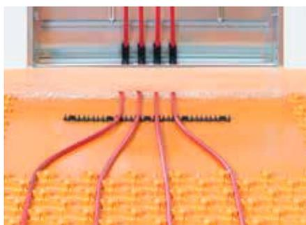
Le panneau de mise à niveau Schlüter-BEKOTEC-ENFGTS se monte dans la zone du collecteur afin de faciliter le montage des tubes de chauffage dans le coffret pour collecteur. Le panneau en polystyrène est fixé sous la dalle à plots à l'aide de la bande adhésive double face fournie (6 m). Le panneau est équipé du même isolant phonique aux bruits de choc que la dalle EN 18 FTS.
