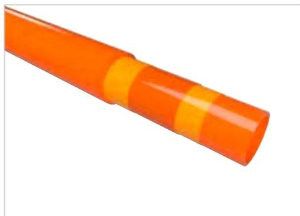
Schlüter-BEKOTEC-THERM-HR est un tube de chauffage à 5 couches en polymère haut de gamme (PE-RT), muni d'une séparation centrale contre la diffusion d'oxygène. Le tube extrêmement souple et conforme à la norme DIN 16833 est spécialement adapté à la pose dans les dalles à plots BEKOTEC. La barrière anti-oxygène est certifiée conformément à la norme DIN 4726 et sa qualité est contrôlée en continu.
