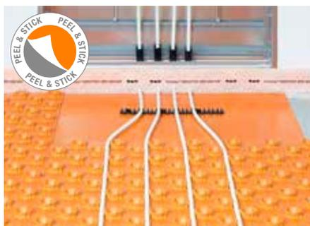
Le panneau de mise à niveau Schlüter-BEKOTEC-ENFGK-PS se pose dans la zone du collecteur afin de faciliter le montage des tubes de chauffage dans le coffret pour collecteur. Le panneau est autocollant au verso et muni d'un film protecteur.
