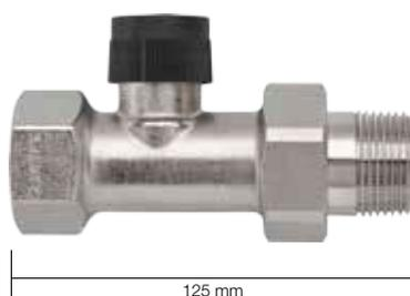
Schlüter-BEKOTEC-THERM-ZV est une vanne pour zone de chauffe qui permet de réguler simultanément tous les circuits de chauffage raccordés au collecteur. La vanne pour zone de chauffe peut être pilotée par une électrovanne Schlüter. La régulation peut être assurée par le biais de la commande BEKOTEC ou par un thermostat DITRA-HEAT-E. Raccordement/matériel : raccord vissé/vanne 1" (DN 25) en laiton nickelé.
