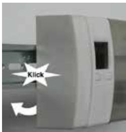
2. Appuyez sur le bas des modules en direction du rail DIN jusqu'à ce que l'enclenchement soit audible.
