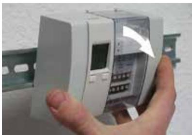
2. Inclinez le haut des modules pour les dégager du rail DIN.
