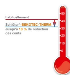
La température de départ chaudière est celle du fluide caloporteur (p. ex. de l'eau) qui alimente le plancher chauffant. La température de départ dépend des surfaces rayonnantes et du besoin calorifique des pièces. Autrefois, elle était de l'ordre de 70 à 90 °C sur des systèmes classiques.
